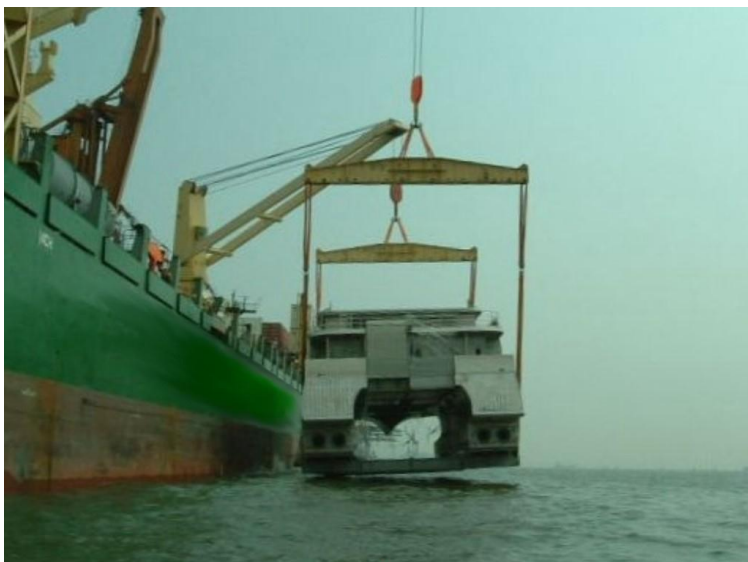
Bild 1.6: Heben eines Katamaran-Rumpfes, geschätzte Schwerpunktlage
