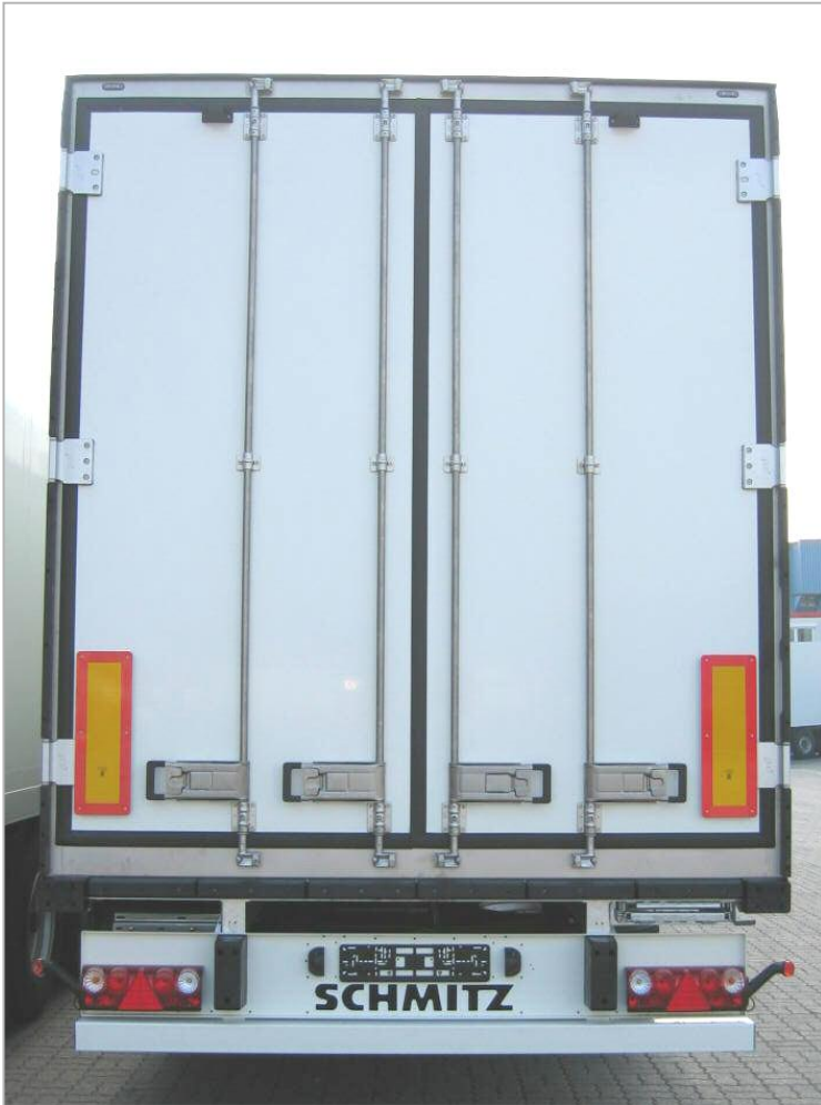
• Dichtung der RWT
