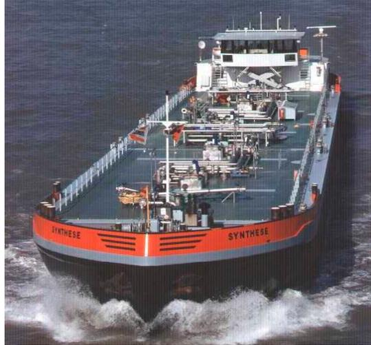
Beispiel für ein modernes Typ N Schiff, das für die Produkte fahrt eingerichtet ist, d.h. es ist für zwei verschiedene Produkte während der Hin- und Rückreise gebaut, die in zwei verschiedenen Arten von Tanks gefahren werden.
