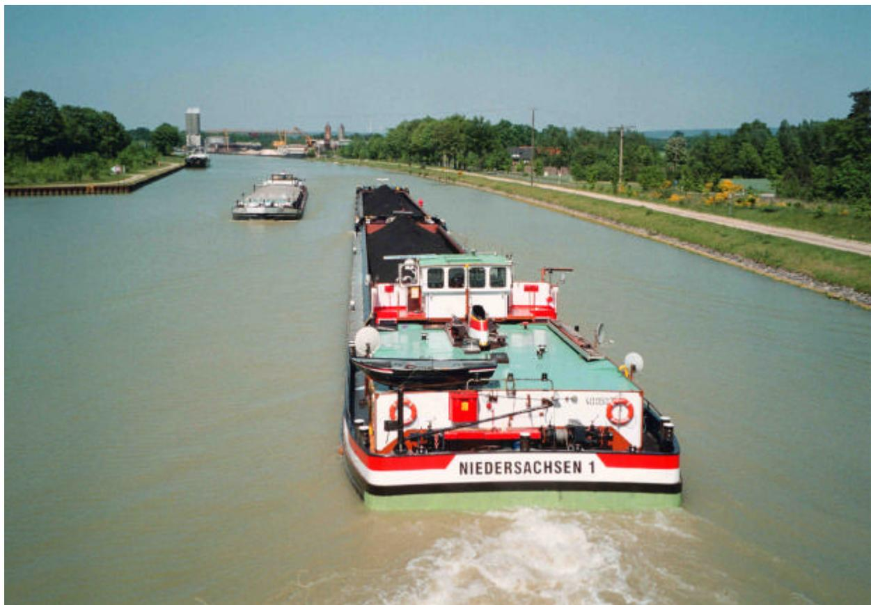
Abb. 19: Koppelverband mit Leichter im Kanal
