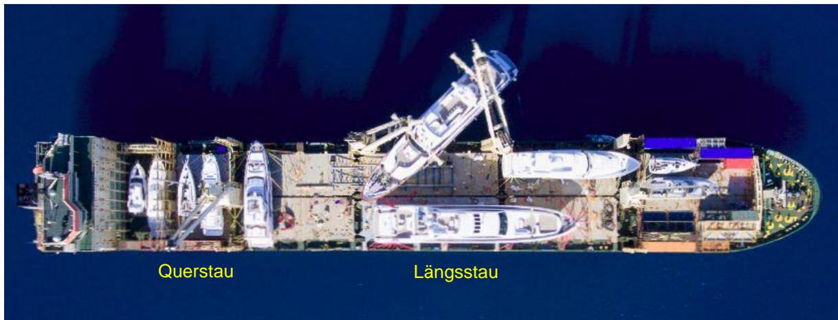
Bild 1: Ladung längs- und querschiffs gestaut
