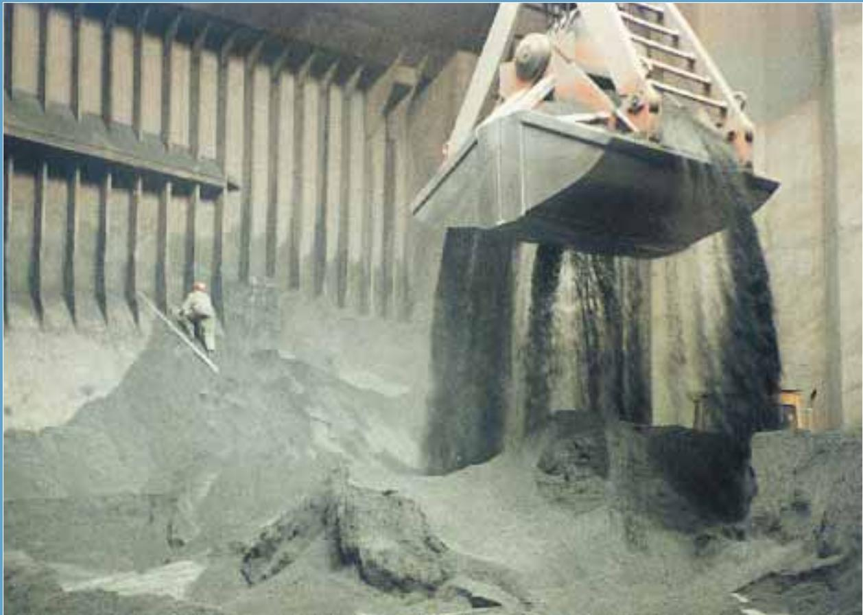
Sehr viele Schüttgüter haften relativ stark an den Laderaumwänden. Diese Anhaftung wird dadurch verstärkt, daß bei Massengutfrachtern die Spanten der Außenhaut in den Laderaum hineinragen. Um diese anhaftende Ladung zu entfernen, werden sehr häufig Preßluft- und Hydraulikhämmer eingesetzt. Selbst bei leichten »Berührungen« durch dGreifer, Radlader oder ähnliches Gerät werden die Farbschichten und das äußere Gefüge des Materials verletzt, das begünstigt die Korrosion.
