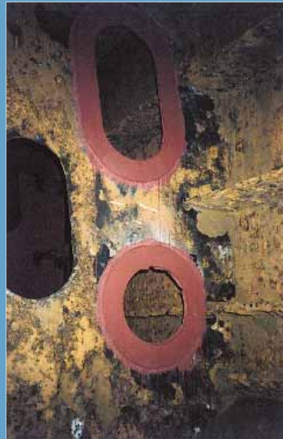
Sehr starke Korrosion im Tank. Schiffsbauerteile mußten ausgewechselt bzw. gedoppelt werden.
