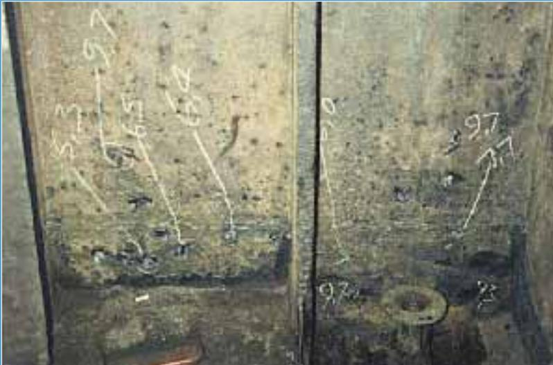
Die Zahlen am Schott zeigen die Tiefen des Lochfraßes (pittings) an. Die Konstruktion ist erheblich geschädigt. Es besteht Reparaturbedarf.
