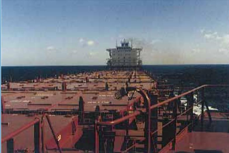
An erster Stelle stehen die Lukenverschlüsse. Die Lukendeckel bedecken häufig Flächen von der Größe eines Fußballfeldes und müssen extremen Belastungen standhalten. Auf Container- und Stückgutschiffen und teilweise auch auf bulk carriern ist es üblich, die Lukenabdeckungen als Decksfläche zu nutzen.
