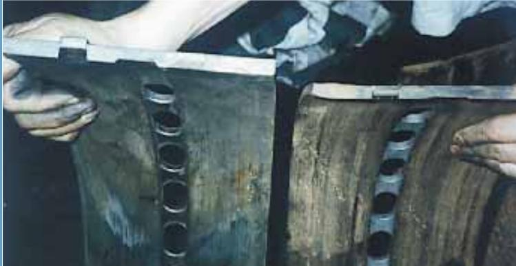
Deformierte und abgeriebene Lagerschalen hätten längst ausgetauscht werden müssen.
