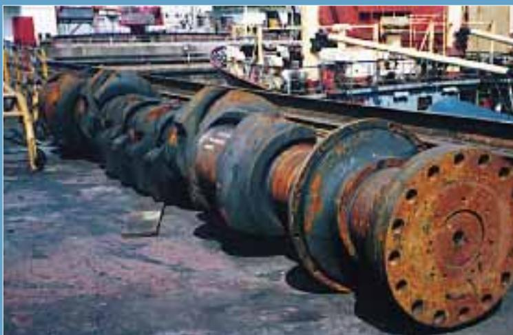
Eine stark geschädigte Kurbelwelle des Hauptmotors mußte gegen eine neue Kurbelwelle ausgetauscht werden.
