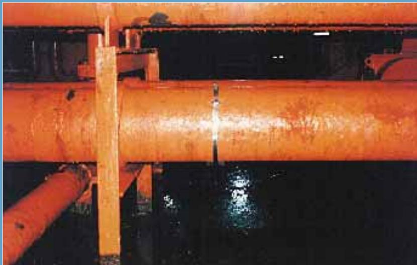
An Deck waren die Pipelines offensichtlich wiederholt dilettantisch repariert worden, so daß während des Ladevorgangs aus den Leckagen Benzin austrat und über Deck in das Hafenwasser gelangte.
