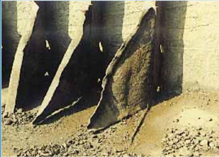
Leider wird allzu oft versucht, mit schweren Gerätschaften (Radlader, Teleskoplader etc.) die Ladungsreste an den Bordwänden zu entfernen. Durch diese naturgemäß sehr »unsanfte« Vorgehensweise wird das Schiff häufig stark beschädigt. So kommt es, daß oftmals mehrere Spanten ihre Aufgaben nicht mehr erfüllen können. Die Konstruktion ist geschwächt, und das Schiff hat eine »Sollbruchstelle« bekommen.
