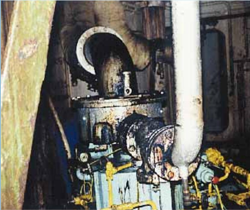
Von ehemals acht Pumpen waren noch fünf an Bord. Von diesen fünf verbleibenden Pumpen waren drei derart ausgewaschen, daß sie zum Fördern von dünnflüssigen Produkten (die Ladung war Benzin) nicht mehr geeignet waren. Darüber hinaus waren alle Pumpen nicht mehr funken-sicher und boten allein dadurch höchste Explosionsgefahr.
