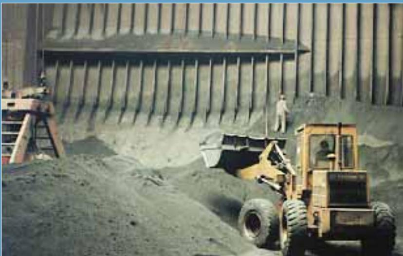
... oder es entstehen Schäden durch Hilfsgeräten, wie z.B. im bulk carrier (Radlader, Preßluft- und Hydraulikhämmer etc.), oder direkt durch die Einwirkung des Löschergerätes, wie z.B. eines Greifers.
