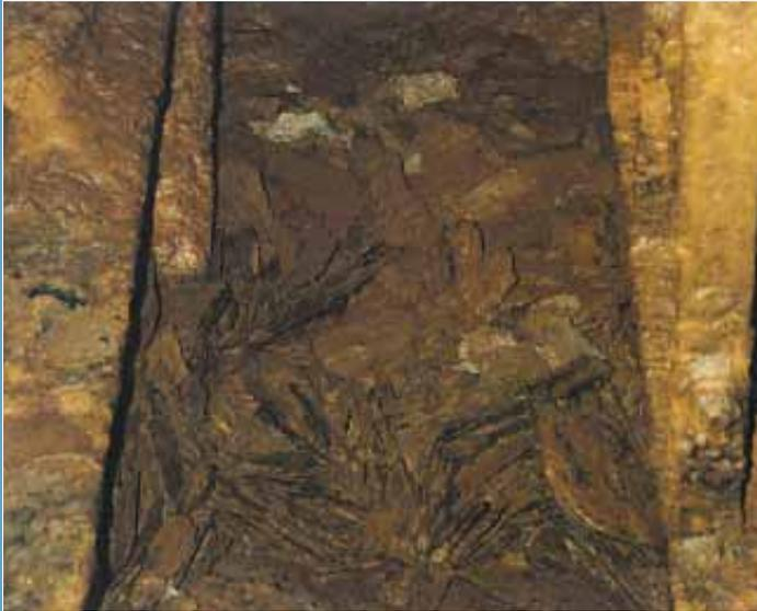
Leider ist  $\text{FeO}_2$ , also Rost, auch elektrochemisch höherwertiger als der Schiffsstahl. Somit zersetzt sich der Stahl zugunsten des ungeliebten Rostes. Rost hat Rost zur Folge und beschleunigt durch seine Existenz die elektro-chemische Korrosion. Deswegen ist es so wichtig, Rost an Bord zu beseitigen. Ausreichende und gründliche maintenance kann Korrosionen extrem verlangsamen.
