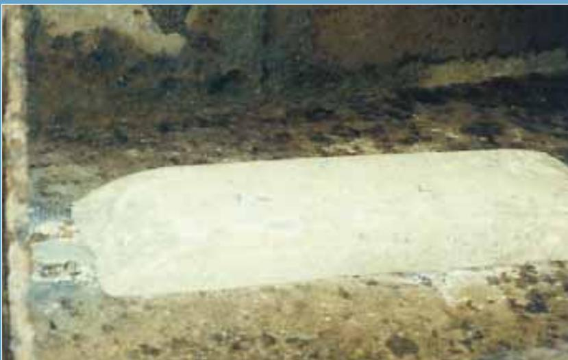
Da Zink elektro-chemisch betrachtet im Verhältnis zu Stahlprodukten ein sehr unedles Metall ist, macht man sich diese Tatsache in Form von Opferanoden zunutze. Diese Opferanoden sind Zinkbarren, die am Schiffskörper angebracht werden. Die sog. Opferanoden zersetzen sich zugunsten des Schiffbaustahls und beeinflussen den Fortschritt der Korrosion am Schiffbaustahl positiv.
