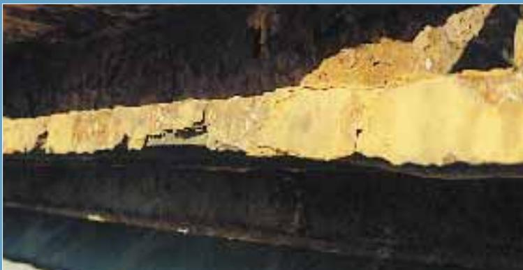
Die Dichtungseinheit, in der das Dichtungsmaterial (Gummi) befestigt ist, ist durch Korrosion schon vollkommen zerstört.
