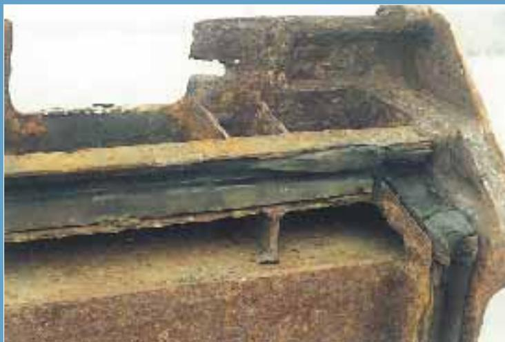
Das Rückstellvermögen des Dichtungsmaterials ist von grundlegender Bedeutung für die Dichtigkeit der Einheit. Mit den Jahren ermüdet das Dichtungsmaterial und führt somit zu Undichtigkeit. Die Randbereiche der Schiffsverschlüsse sowie die Schiffsverschlüsse selbst erfordern eine höhere maintenance als die übrige Konstruktion. Wird diese maintenance nicht sichergestellt kommt es sehr schnell zu Dichtigkeitsproblemen im Lukendeckelbereich und »automatisch« zu Ladungsschäden.
