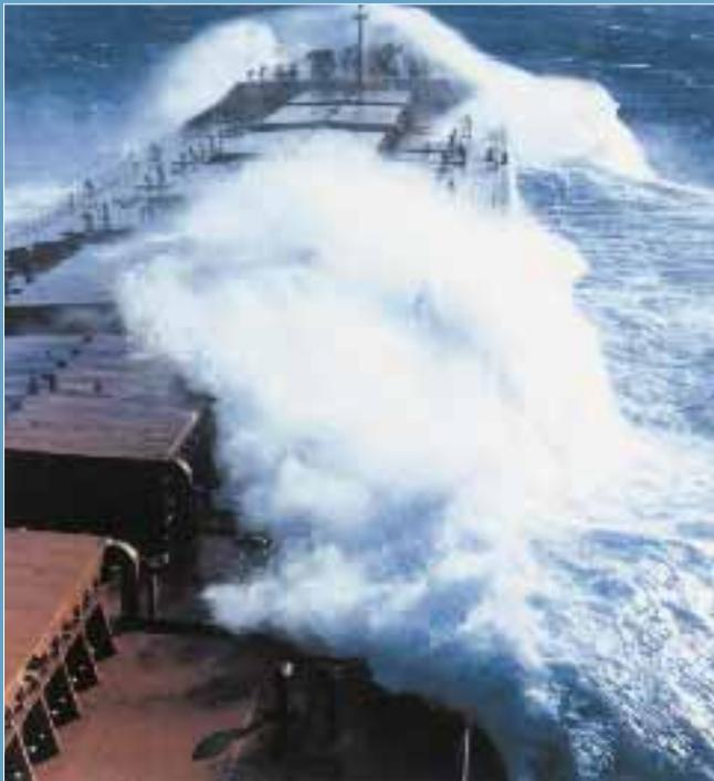
Lukenabdeckungen müssen über die Lebensdauer eines Schiffes absolut wetterdicht sein, wobei die Belastungen durch ungeheure Mengen von Wasser, die bei schwerem Wetter an Deck gespült werden können, aufgrund der Wucht und der Menge erheblich sein können.
