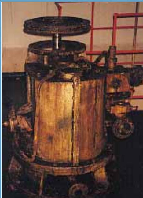
Das an Bord befindliche Material entpuppte sich als eine Ansammlung von Pumpenwracks. Zum Löschen der Ladung mußten ausschließlich Fremd-pumpen eingesetzt werden.
