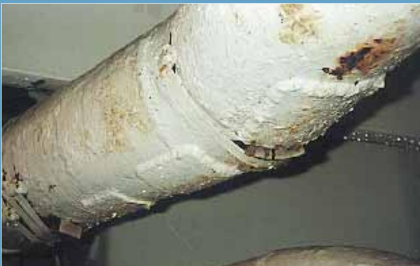
Flicken an Flickern. Der Zustand des Rohrleitungssystems unter Deck war noch weit aus katastrophaler. »Reparaturen«, wie auf Seite 38 beschrieben (Gummi, Stahlbänder/Stahlblechflicken), waren hier in allen Facetten anzutreffen. Auch Leitungen in den Tanks waren mehrfach »repariert«.
