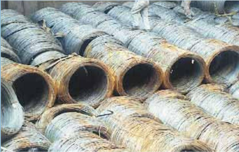
Durchgehend korrodierte wire rod coils. Das Seewasser hat ganze Arbeit getan.
