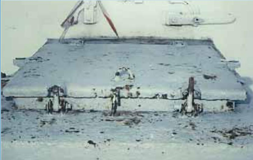
Die ständigen mechanischen Beanspruchungen der Schiffsöffnungen führen sehr schnell zur Zerstörung der schützenden Farbschichten. Vor allem sind es die Randbereiche, die zuerst geschädigt werden und der Korrosion eine Angriffsfläche bieten.
