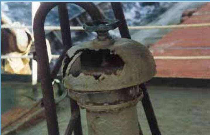
Lüftungseinheiten und Einstiegsmöglichkeiten in die Luken und Deckshäuser sind mechanisch nicht so stark belastet wie die Lukenabdeckungen. Sie werden deshalb bei Maintenancearbeiten oft vergessen.
