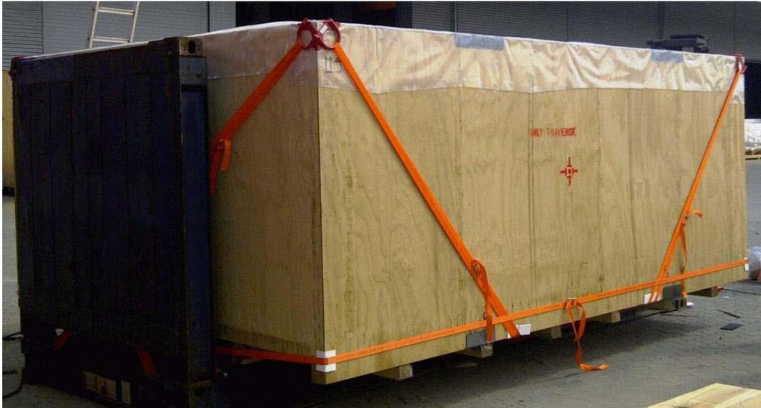
Bild 8: Sichern mit Buchtlaschings und Direktlaschings (Quelle: Cordstrap)
